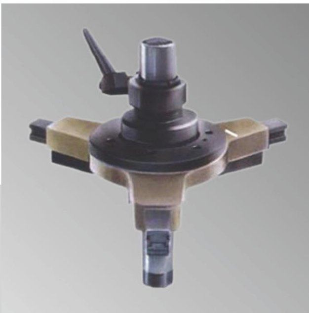
* 3"~12"까지 Valve Body 장착하여 spindle을 구동시키는 chuck
